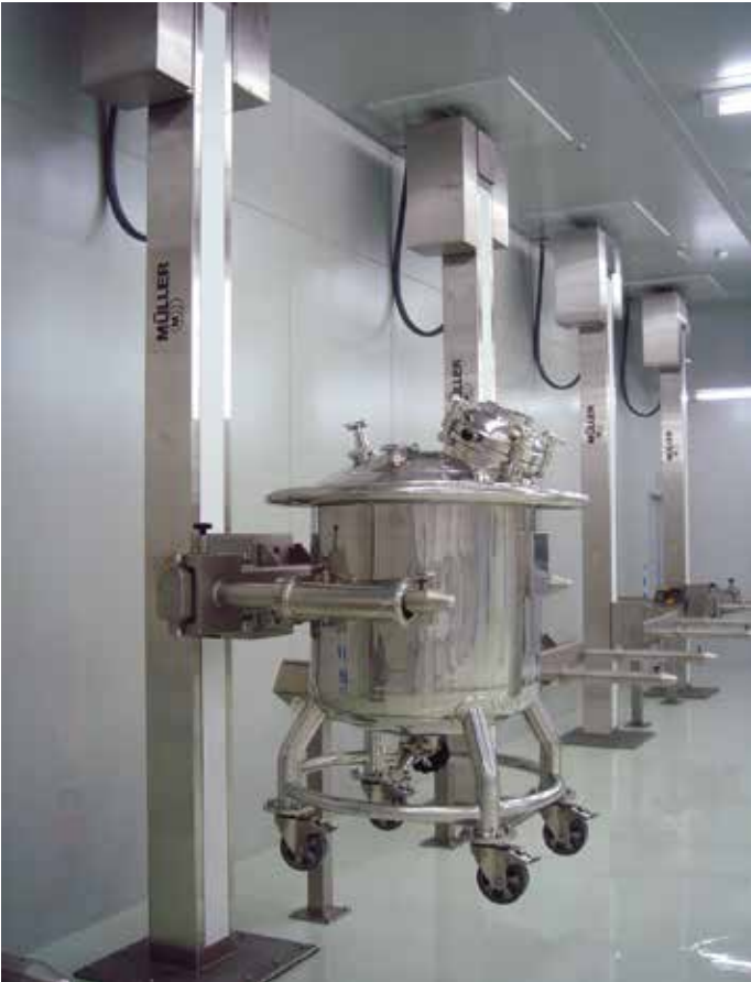
Hubsäule mit Dorngreifer zum Handling von Prozessbehältern im Reinraum.
